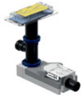
Geberit-asennussarja sivuliitännällä Cleanline-sarjan suihkukouruille, lattian rakennekorkeus kaivon kohdalla 180–310 mm: d=50mm 154.159.00.1, LVI-NRO 5815113
