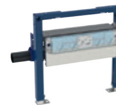
Geberit Duofix -suihkuelementti 50 cm, seinäkaivolla, lattian rakennekorkeus kaivon kohdalla 65–90 mm 111.593.00.1, LVI-NRO 5756782
