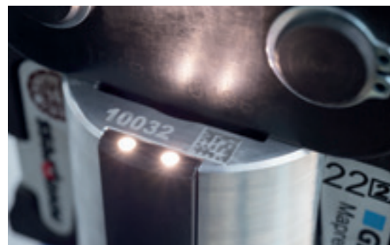
Integroitu työvalo puristustyökaluissa Geberit ACO 203plus, ECO 203 ja ACO 203XLplus takaa hyvän näkyvyyden myös pimeissä olosuhteissa.
